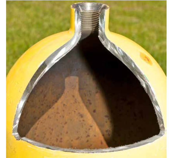
Aufgeschnittene Stahlflasche mit M25 Gewinde nach der älteren DIN 477 Norm (abgeschrägte O-Ring Nut). Im Innern hat sich Flugrost gebildet, doch der ist in diesem Ausmass harmlos.
